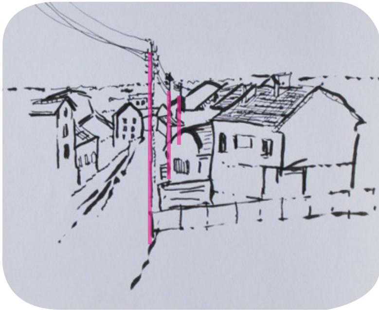
Les derniers éléments seront représentés avec un stylo fin: poteaux et lignes électriques, fenêtres, matériaux toitures, cheminées... ce sera plus facile de dessiner avec précision avec une mine fine, le trait fin participe aussi à donner une échelle. Les formes structurantes principales seront représentées avec des traits épais et les détails avec des traits fins. Ici nous avons aussi une épaisseur de trait intermédiaire.
