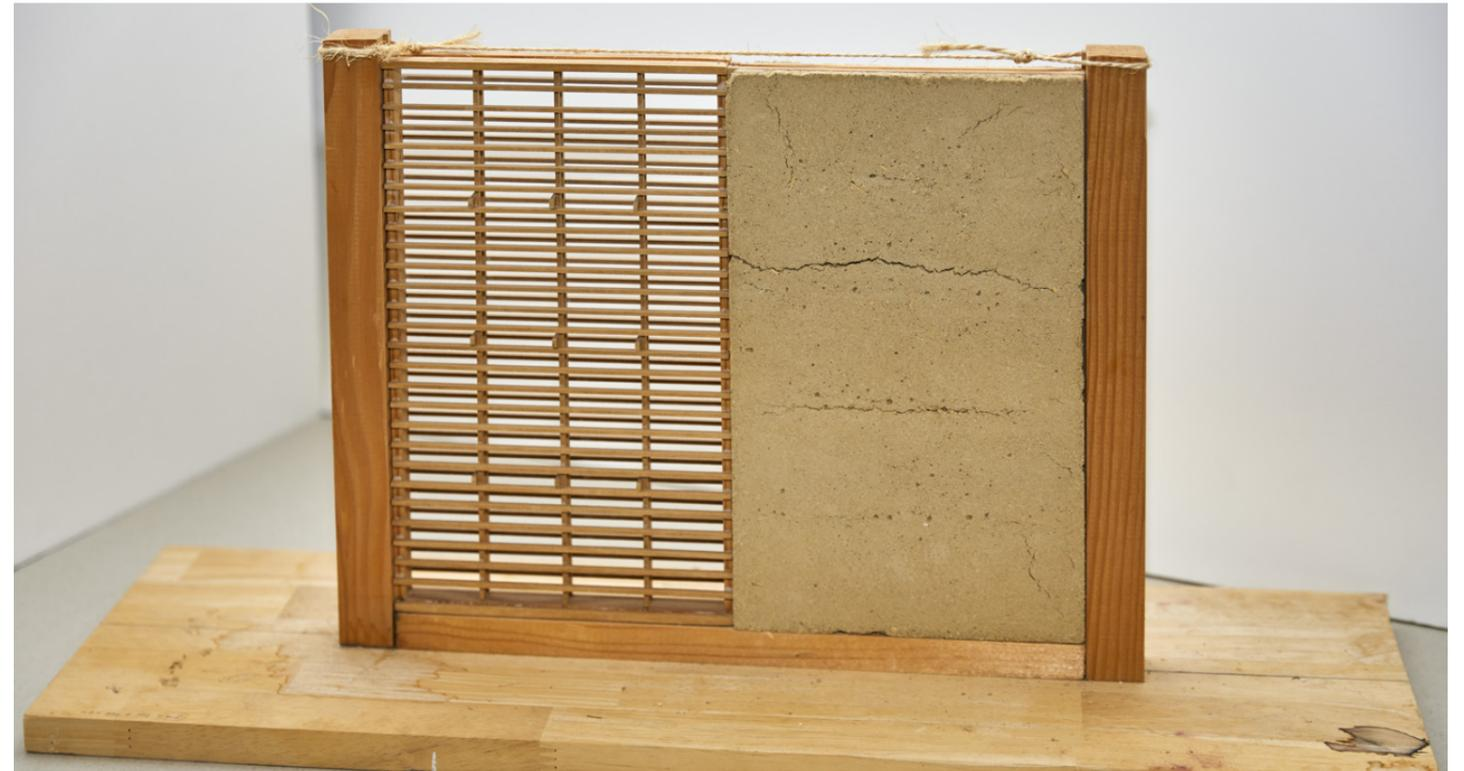
Maquette des murs en terre coulée non stabilisée
