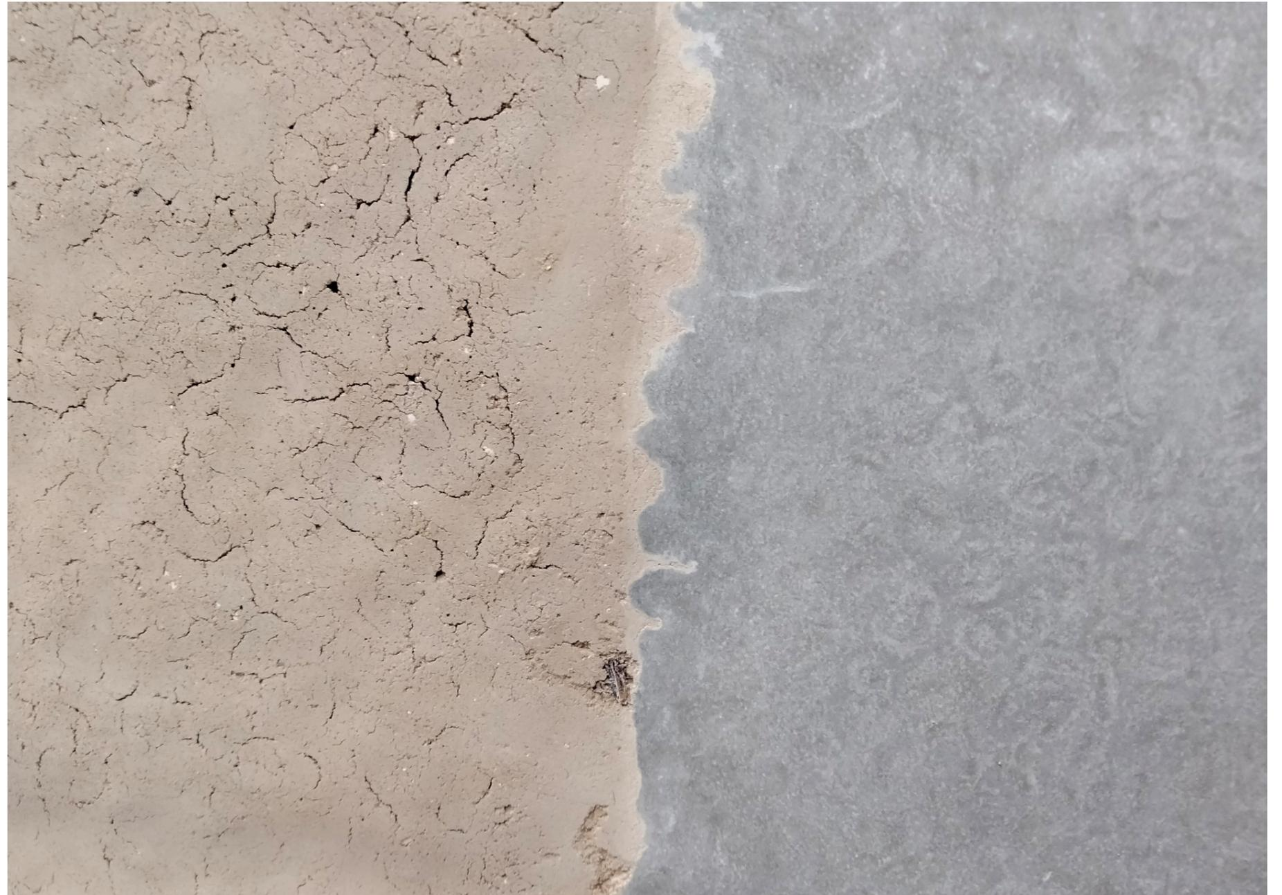
Coulage simultané de terre crue et de béton de ciment, réalisé à l'agence
