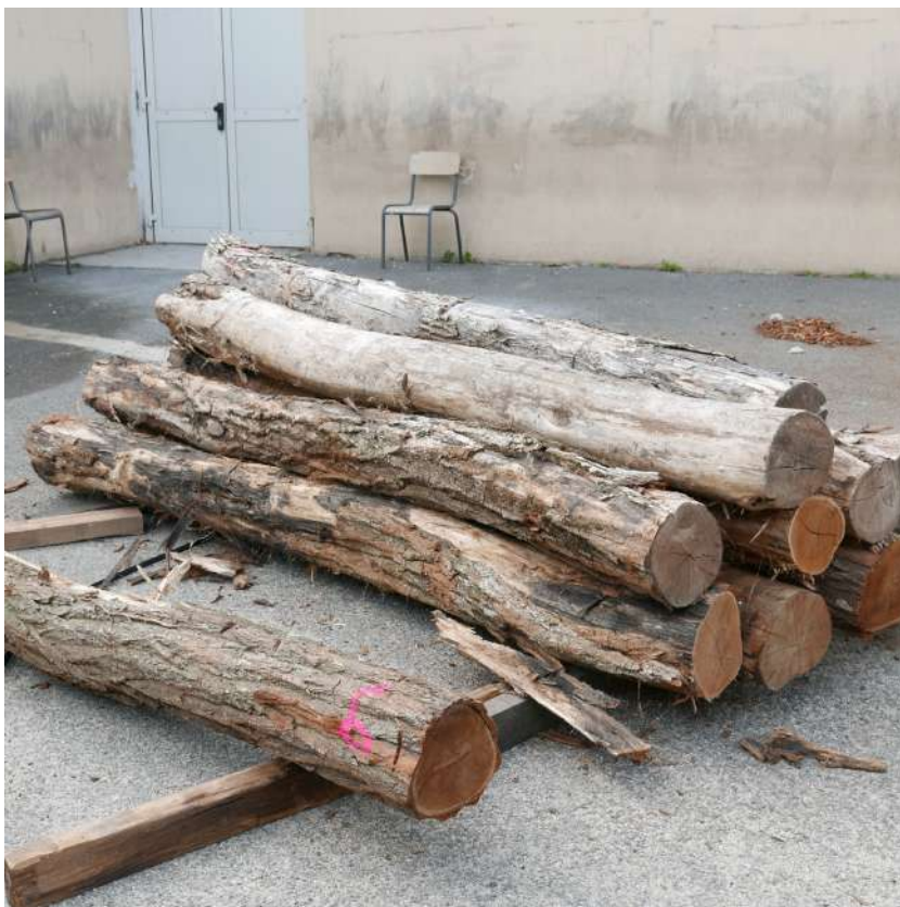
Pieux de robinier avant mise en oeuvre. Local vélo du centre de loisirs Jacques Chirac. Rosny-sous-Bois. 2020. © Maëlle Valfort
