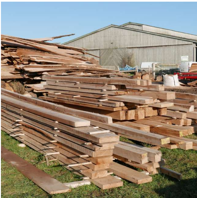
7. Stockage des planches et des sections connexes (arrière plan : stockage des dosses) © Ville de Rosny-sous-Bois
