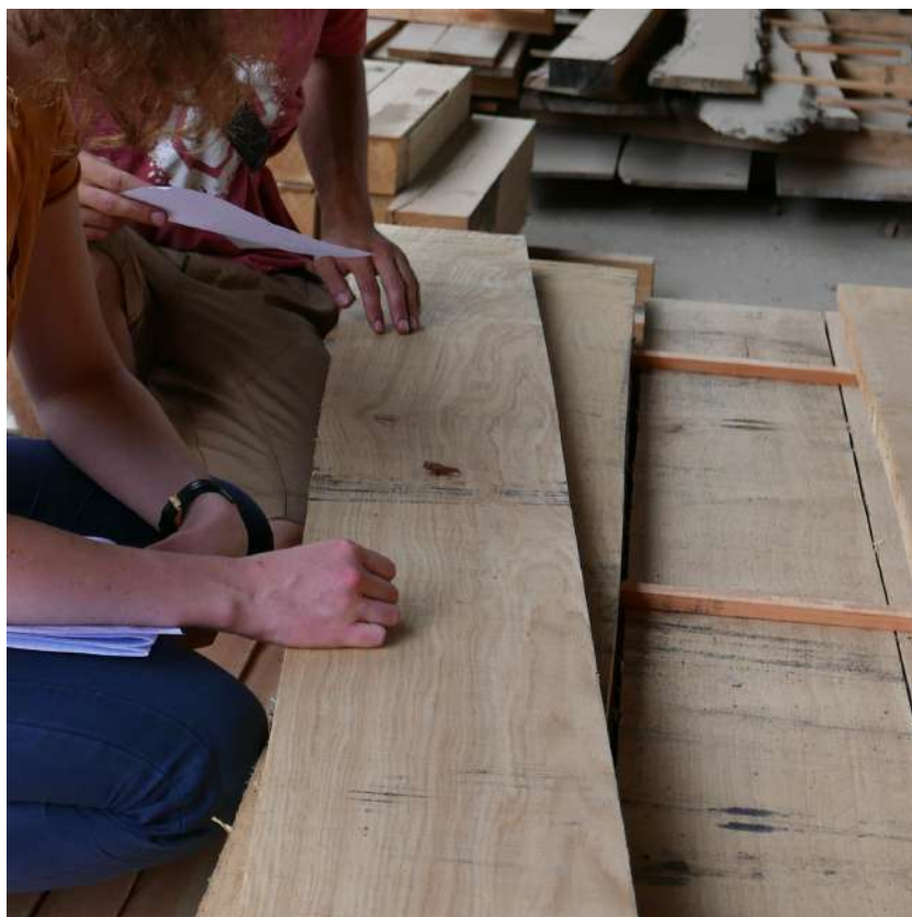
Identification des singularités. Scierie Roëser. Crécy-la-Chapelle (Seine-et-Marne). 11 juillet 2019. © Ville de Rosny-sous-Bois
