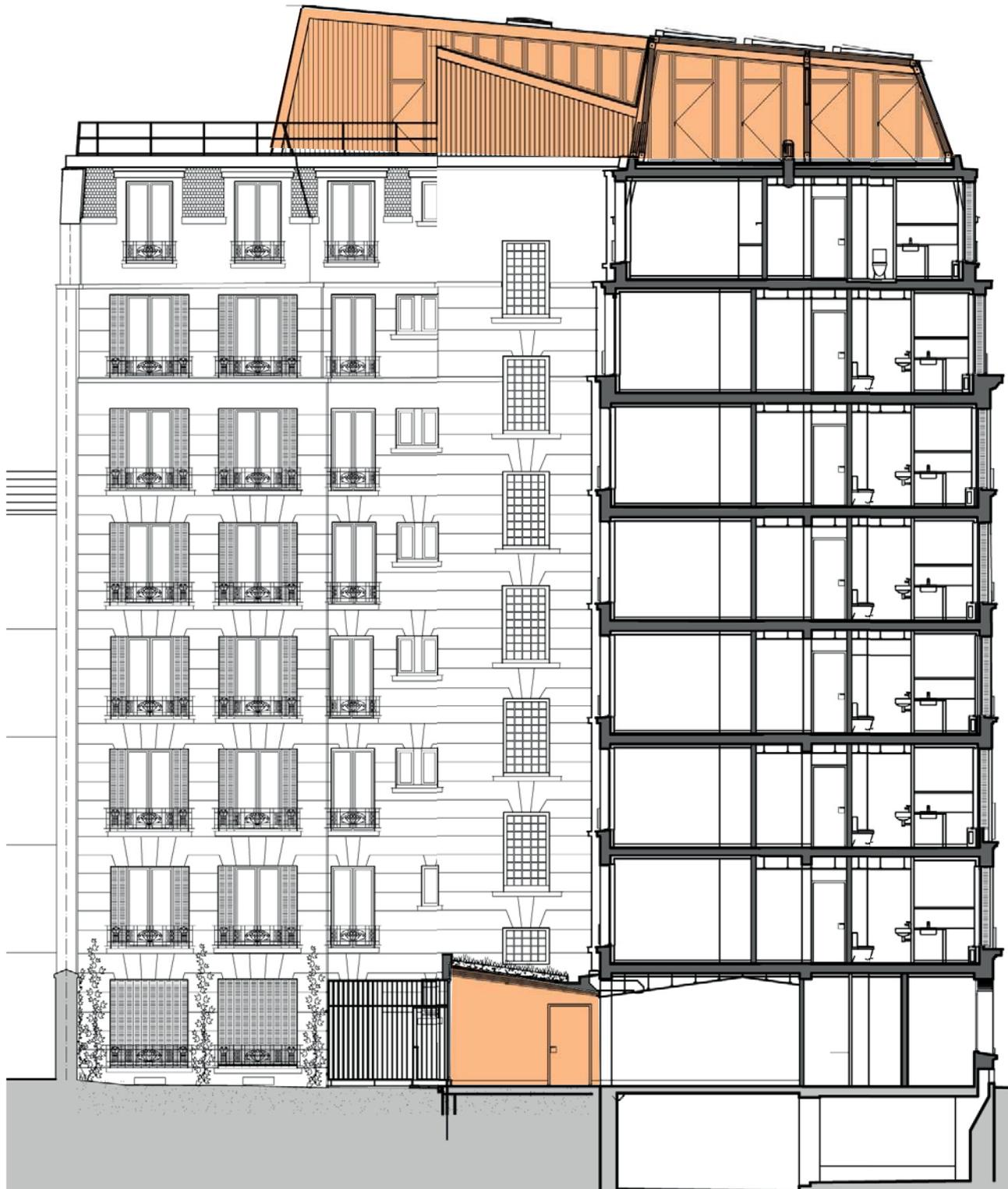
Vue en coupe du bâtiment. Deux extensions apparaissent : l'une au rez-de-chaussée s'ouvre sur la cour jardin ; la seconde, en toiture, repose sur le bâtiment existant.
